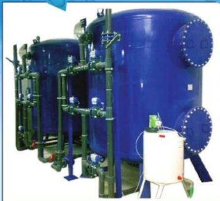
Sudaki sertliğe sebep olan Kalsiyum ve Mağnezyum iyonlarının Kuvvetli Katyonik Reçine kullanılarak sudan uzaklaştırılmasını sağlayan sistemlerdir. Sert Su özellikle ısıticili cihazlar, sıcak su tesisatları, buhar kazanları gibi yüksek sıcaklıkta su kullanılan ünitelerde kireç taşı oluşturarak hatların tikanmasına bu sebeple enerji sarfyatlarına ve ısı transfer kayıplarına yol açmaktadır.
